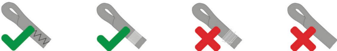
Tiene que estar disponible el remate refuerzo de cabo con las puntadas de seguridad que evitan la apertura gradual del ojo. El ojo no debe tener una longitud superior a 25 mm (medida en el interior del ojo). Hay que desechar el producto si tiene la funda dañada:
