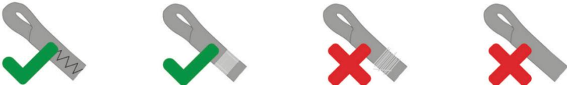
Das Takling mit den Sicherungstichen, die ein schrittweises Öffnen des Auges verhindern, muss vorhanden sein. Das Auge darf nicht länger als 25mm sein (gemessen im Inneren des Auges).
