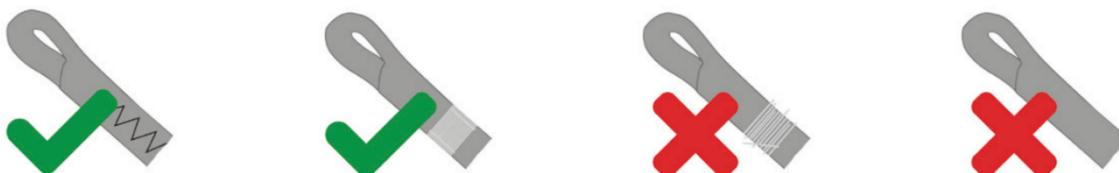
Musí být přítomné ovinutí zajišťovacími stehy bránícími postupnému rozevření oka. Oko nesmí být delší než 25 mm (měřeno uvnitř oka).
