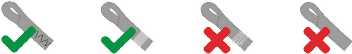
I øyet er en del av taukjernen fjernet, og det er mindre materiale som kan bære lasten. Taklingen med sikkerhetsstingene som forhindrer en trinnvis åpning av øyet, er påkrevet. Øyet må ikke være lenger enn 25 mm (målt inne i øyet).
