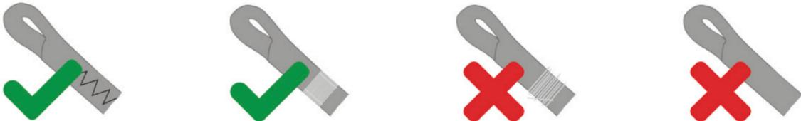
Silmukan asteittaisen avautumisen estävän rihmauksen varmistusompeleilla on oltava paikoillaan. Silmukka ei saa olla pidempi kuin 25 mm (silmukan sisäpuolelta mitattuna). Jos kuori on vaurioitunut, tuote on poistettava:
