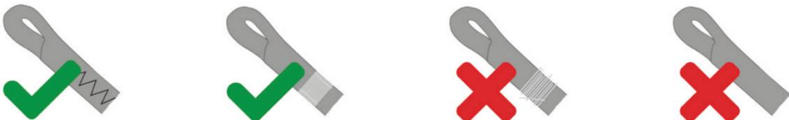
Dev'essere presente la piombatura fermata tramite apposite cuciture che impedisce la progressiva apertura dell'occhiello. L'occhiello non dev'essere più lungo di 25 mm (misurato all'interno dell'occhiello).
