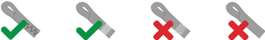
La surliure doit être présente et disposer des points de sûreté qui empêchent une ouverture progressive de l'œillet. La longueur de l'œillet ne doit pas dépasser 25 mm (mesure effectuée à l'intérieur de l'œillet).
