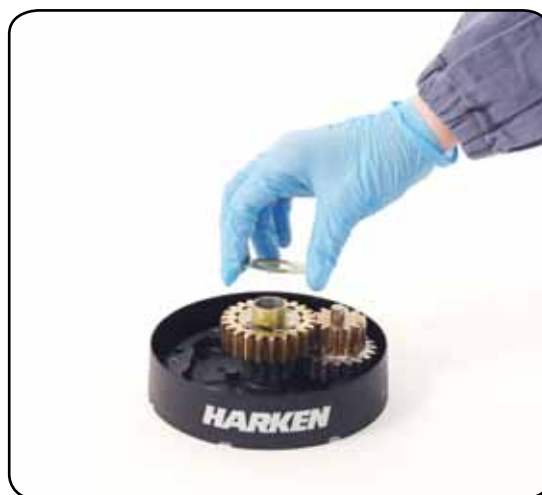
11. Remove the washer n°12
